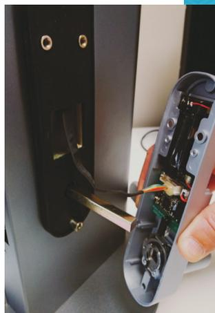
På låser med dråpeformet låssylinder festes monteringsbraketten ved å benytte 3 av de medfølgende maskinskruene fra baksiden. De 2 øverste skruene skal ha samme lengde som dørens tykkelse. Den nederste skal være 2 gjengestykker lenger enn døertykkelsen.
