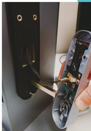
5 Skru deretter fast innerdelen til braketten med de 3 korte medfølgende maskinskrueene. 1 under håndtaket (den lengste av de), og de 2 korteste gjennom batteriholderen på hver sin side øverst.
