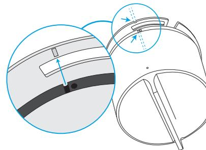
11. Vri dørlåsen med klokken til den klikker for å feste den til bakplaten. MERK: Hvis du trenger å løsne og forsøke, se 'Avinstaller instruksjoner'.
