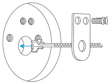
6. Finn bakplaten i dørlåsboksen og fjern papiret fra de tre klistremerkene på baksiden av bakplaten. Plasser bakplaten hvor vrideren pleide å være. Det runde hullet i midten er for sylinderpinnen. Bruk de 2 skruene (brytbare lange skruer) fra vrideren for å feste bakplaten.
