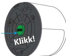
9. Monter dørlåsen over bakplaten med batteridekslet vendt nedover. sylinderpinnen føres inn i adapteren og bakplaten haker inn i låsens bakside.
