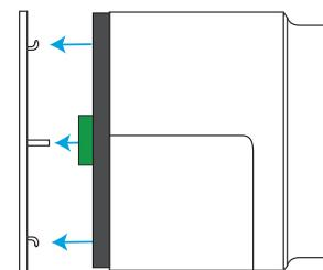
10. Finn den lille merkingen på kanten av bakplaten og juster den med hullet i dekslet rundt dørlåsen. Nå er du sikker på å treffe hakene på bakplaten med dørlåsfestet.
